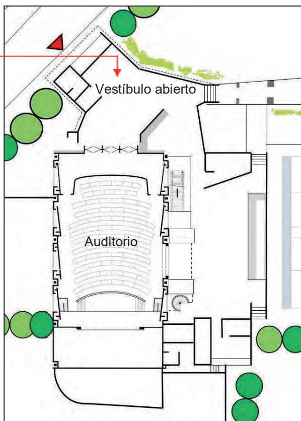
Imagen 298: Planta arquitectónica bloque administrativo (1ero y 2do piso) vestíbulo, oficinas y auditorio antiguo colegio Liceo Bolívar. Se observa el manejo formal y espacial que induce las circulaciones a dichas áreas del edificio. Se contempla a nivel de la segunda planta el vacío sobre la zona de las escaleras; una de un tramo y otra opuesta a esta en forma circular. Fuente: Archivos originales de Civilco Ltda.
