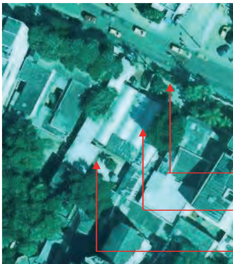
Imagen 140: Fachada Principal sede Universidad del Sinú. Localización e implantación general. Se observan las cuatro bóvedas de cañón que constituyen su cubierta. La edificación presenta un retranqueo general a nivel de paramento con una gran terraza social arborizada que da hacia la calle Real del Pie de la Popa. Un patio posterior, también arborizado, complementa el esquema bioclimático de la casa.
