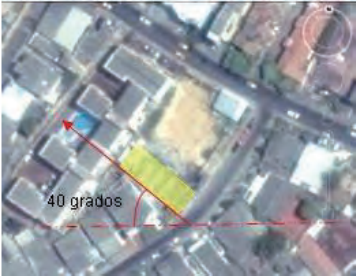
Imagen 134: 2016. Implantación casa Digeronimo con relación al asoleamiento en una disposición de 40 grados con respecto al norte. Fuente: IGAC, archivo personal.
