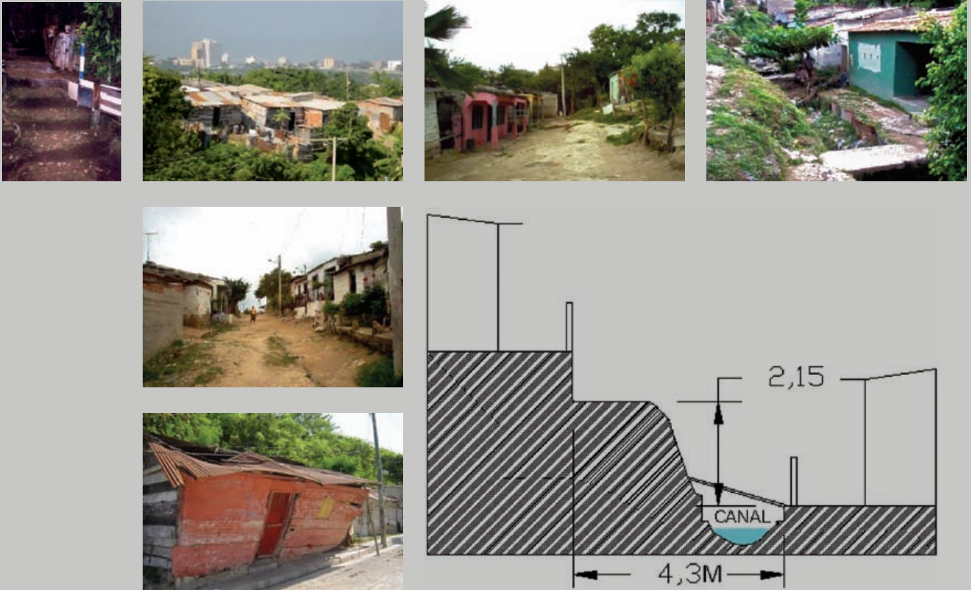
Figuras 35-41. Imágenes y corte que ilustran el estado de algunas calles y casas que se ubican en las rondas de los arroyos o desagües naturales del cerro (Taller VI USB Cartagena, 2006).
