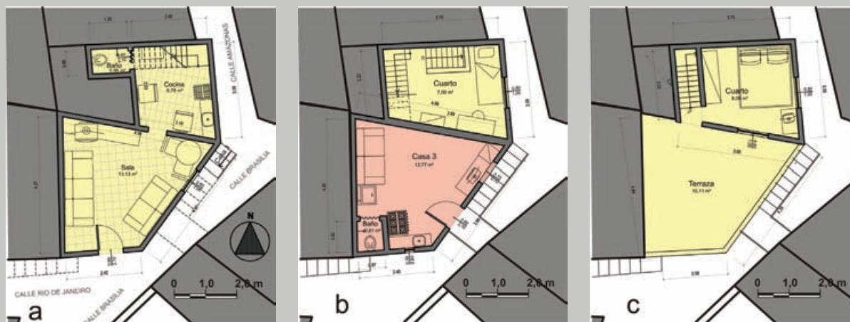
Figura 25. Plantas de la construcción de las casas 2 y 3. 25a: Planta Baja. 25b: Primer piso. 25c: Segundo piso. Fuente: autora/2007.
