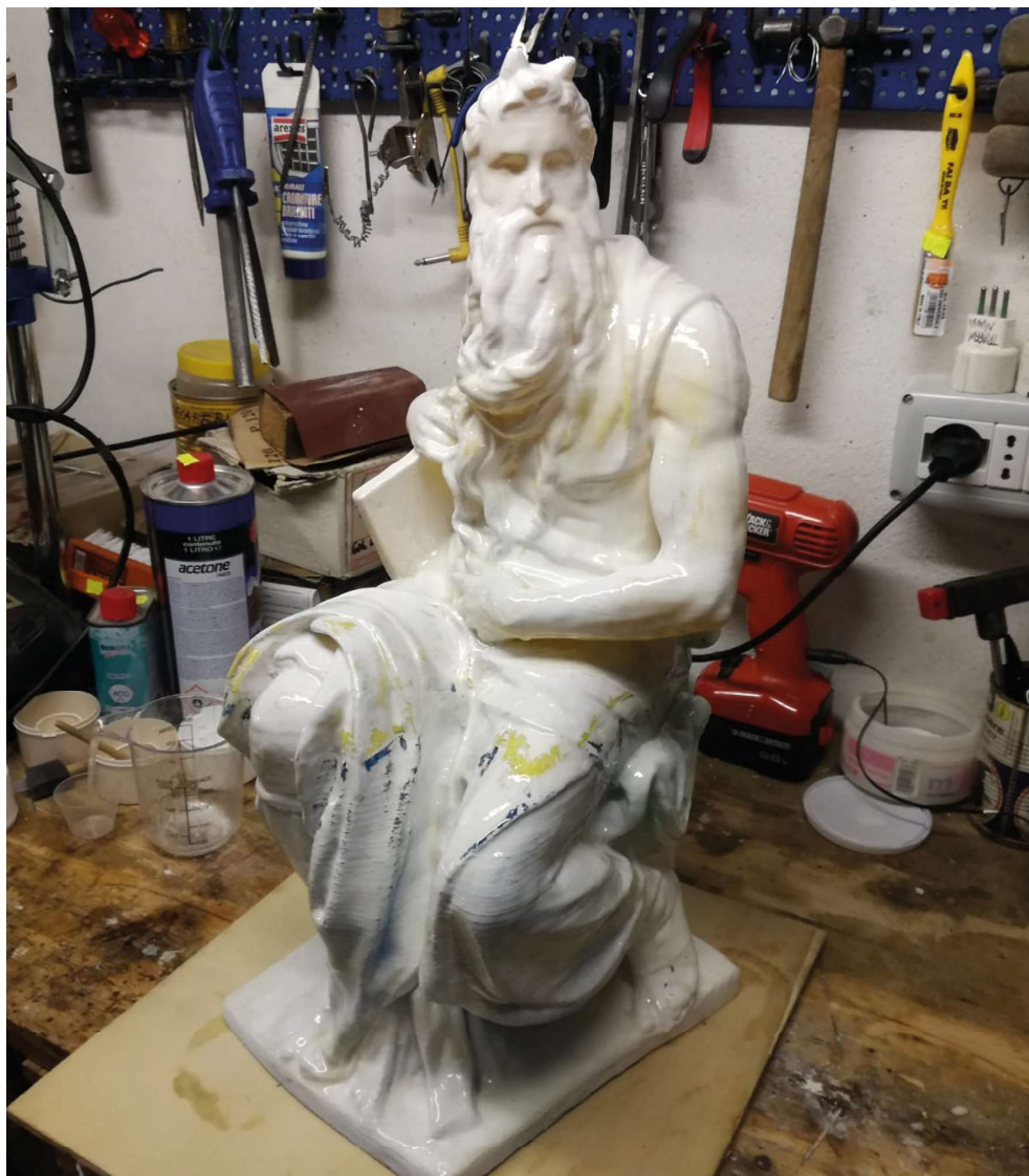
Figura 6. Stampa 3D del modello dell'intera tomba (a) e della statua del Mosè (b) prima dell'applicazione della finitura per uniformare la superficie.
