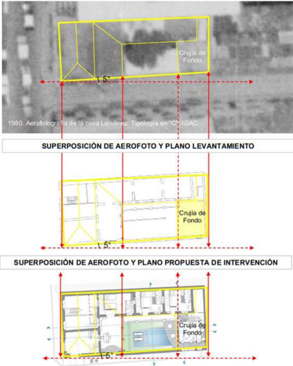
Figura 5. Método de superposición fotográfica (1980) con relación al levantamiento y al plan de la propuesta de intervención.". Superposición del plano de levantamiento (en amarillo) sobre la propuesta. Se observa que el volumen nuevo (crujía de fondo), recupera las mismas dimensiones que tuvo, siendo reinterpretada su materialidad con criterios de contemporaneidad.
